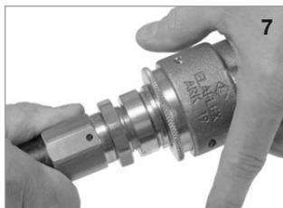
Schiebehülse loslassen – sie bleibt in der Position. Ausreißteil zügig bis zum Anschlag einstecken; die Schiebehülse schnappt nach vorn. Kupplung auf Dichtigkeit prüfen.
