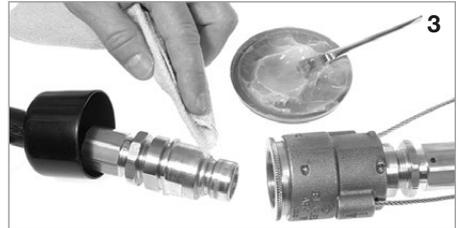
**ARK** Kupplungsteile säubern. Bei Schäden (z. B. der O-Ring Dichtfläche des Ausreißteils, Deformationen, gebrochenen Kunststoffteilen, beschädigtem Zugseil) muss die **ARK** ausgetauscht werden. Außer dem sichtbaren O-Ring EO 146 LT sind keine Einzelteile lieferbar. Gehäuse und Ausreißteil dürfen nicht einzeln ersetzt oder ausgetauscht werden.
