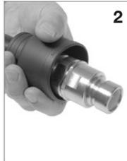
Break Sleeve **BS 19** über Ausreißteil und Schlaucharmatur zurückschieben.
