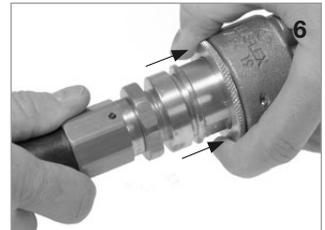
Ausreißteil in das Gehäuse einführen.
