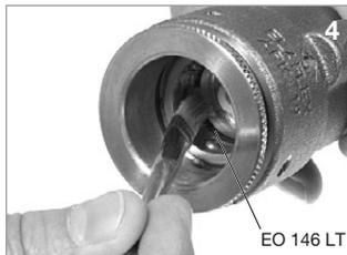
Im Gehäuse den O-Ring dünn einfetten.
